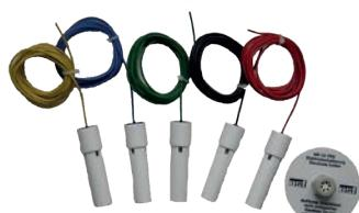
5 навесных электродов в защитном кожухе из пластмассы и держателем электродов. Кабель различных цветов 3 м (устойчив к воде и озону).
